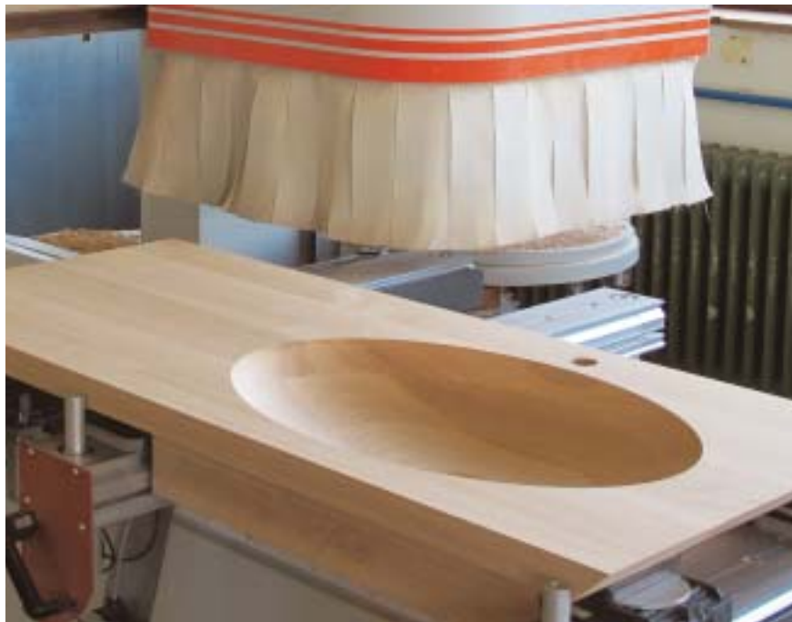
/ Perfekt programmiert und aus dem Vollen gefräst: Abgestimmte Software, Maschinen- und Werkzeugtechnik liefern beste Bearbeitungsergebnisse bei Boos.
