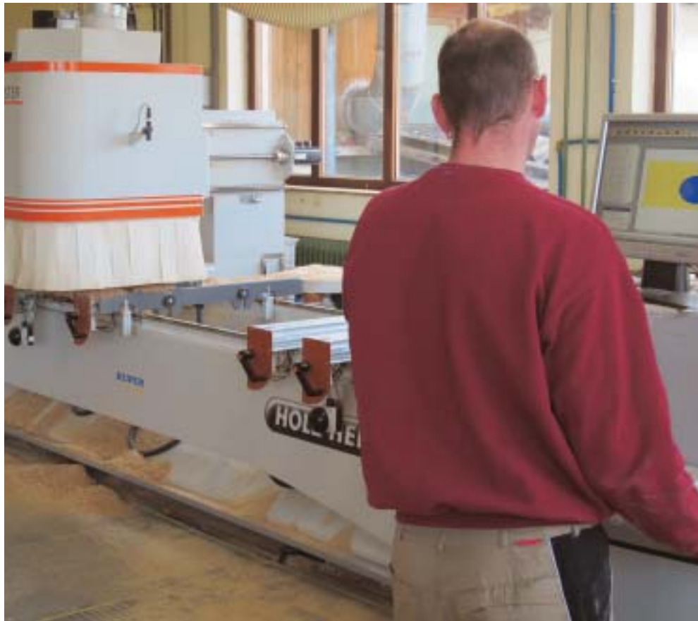
/ Bedienerfreundlich: Die offene Maschinensoftware der Easy Master 7018 von Holz-Her und das Softwarepaket TopSolid Wood ermöglichen schnelle Wege zum NC-Programm. (BM-Fotos: Manfred Maier)
