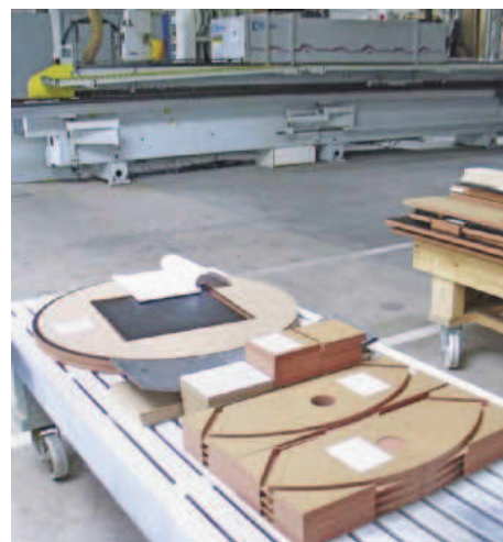
/ Die auf dem BAZ gefrästen Teile sind fertig zum Lackieren bzw. für die Montage. Der rechte Plattenstapel ist auf dem Weg zur Kantenleimmaschine.
