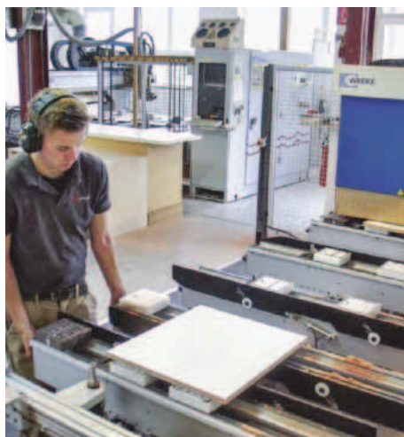
/ Zwei Bearbeitungszentren erledigen die Fräs- und Bohrarbeiten. Eine Schnittstelle überträgt direkt die benötigten WoodWop-Files.
