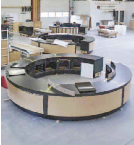
/ Probelauf: Nichts wird hier dem Zufall überlassen. Jedes Objekt wird komplett montiert, kontrolliert und danach wieder für den Transport demontiert.
