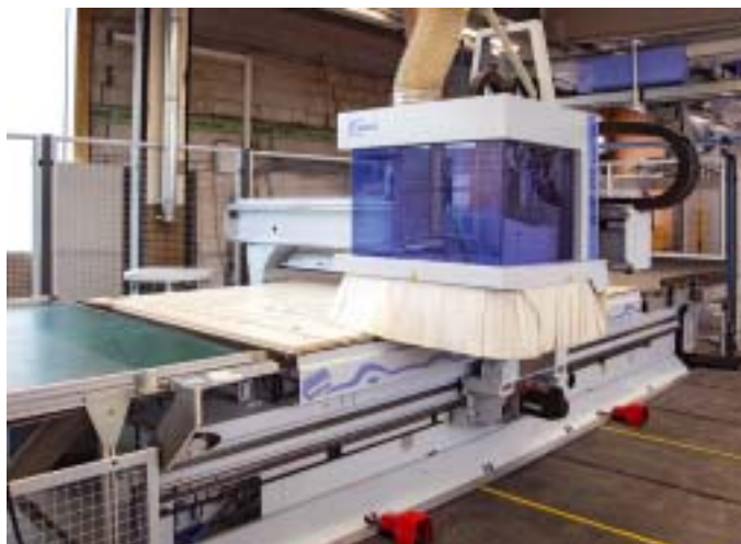
Alle zehn Minuten eine fertig aufgeteilte Halbformatplatte: Der Materialfluss erfolgt vollautomatisch
