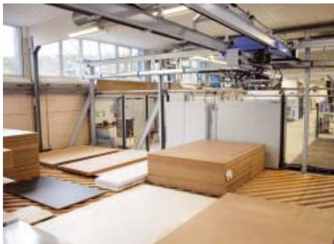
Das Lager erhält den Produktionsauftrag von Top Solid Wood. Es legt die Reihenfolge fest und beschickt die Nestingmaschine
