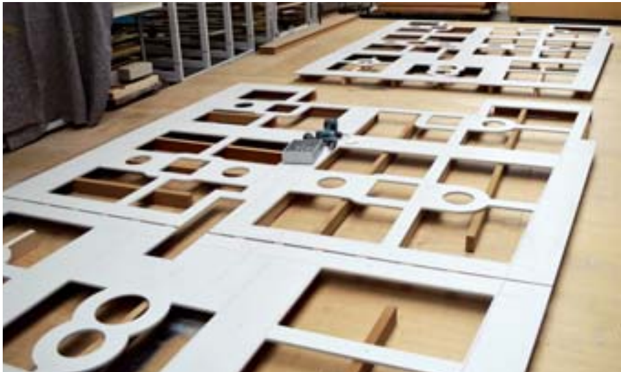
CNC-gefrästes Deckenelement mit Aufnahmen für Lautsprecher, Leuchten, Lüftung ...
