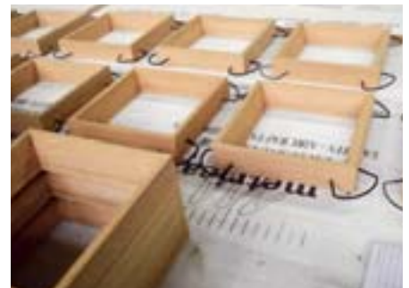
Passen in die Deckenausfräsungen: Eichenholzrähmchen für LED-Leuchten
