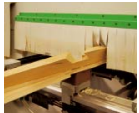
Die Fünfachmaschine Rover A von Biesse fräst ein Tischbein des Modells Xaver
