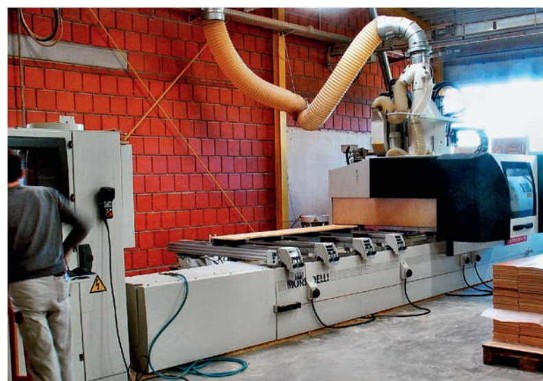
... um dann sicher „real“ bearbeitet zu werden. Auf dieser Maschine werden insbesondere die zahlreichen gerundeten Bauteile produziert
