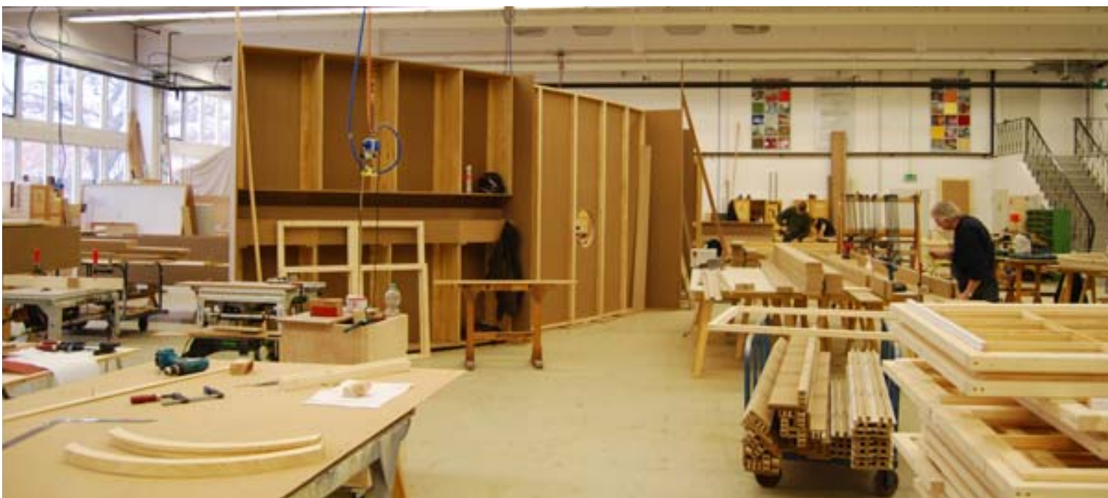
Blick in die Schreinerei des Art Departments: Hier entsteht Dreidimensionalität durch das Biegen von Platten um genestete und gefräste Spanten
