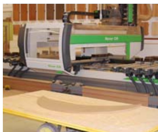
Für größere Nestingaufträge lässt sich eine Opferplatte auf die Traversen aufliegen
