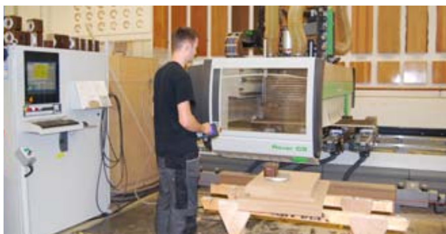
Tischlergeselle Bruno Wolz fräst Spanten auf dem neuen 5-Achs-Bearbeitungszentrum. Die Saugerpositionen hat er im Top-Solid-Modul zugewiesen
