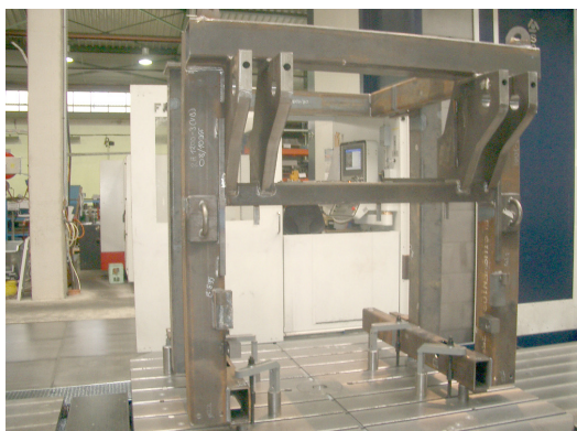
Original und virtuelle Kopie: Dank der hocheffizienten 3D-Simulation wird Rüstzeit gewonnen, die die aufwendige Fertigung der großen Hubrahmen kosten- und zeiteffizient macht.
